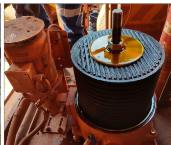
Inserto de filtro CJC® B 27/27 usado - saturado com sujeira.
